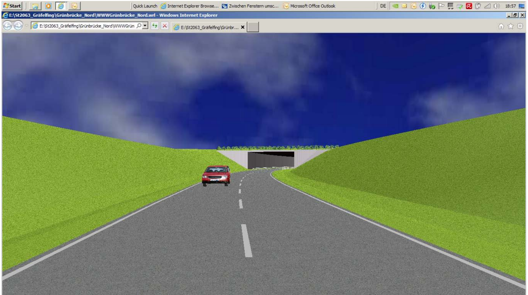
Neue Ortsumfahrung in Troglage (2 m unter Geländeniveau, mit Lärmschutzwällen)
